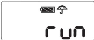
La visualizzazione sul display della scritta **RUN** indica che la centralina è in funzionamento ciclico e dopo due secondi viene visualizzata la pagina principale di default con orologio e indicazione di carica della batteria. In questa pagina i tasti **+**, **-**, **NEXT** e **CONFIRM** non hanno nessun significato: se premuti non attivano nessuna reazione.
