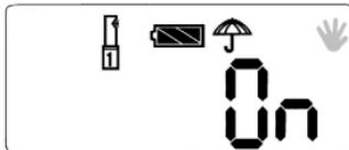
Dopo l'impulso di apertura fornito all'elettrovalvola viene visualizzata a luce fissa l'icona dell'irrigatore e la scritta **ON** sul display numerico.
