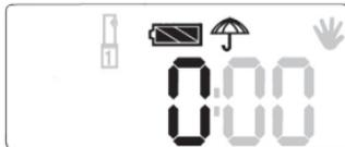
Utilizzare i tasti funzione **[+]** e **[-]** per impostare la durata in minuti del tempo d'irrigazione. Alla prima accensione della centralina o se non ci sono dati programmati in precedenza il display numerico visualizza zero.
